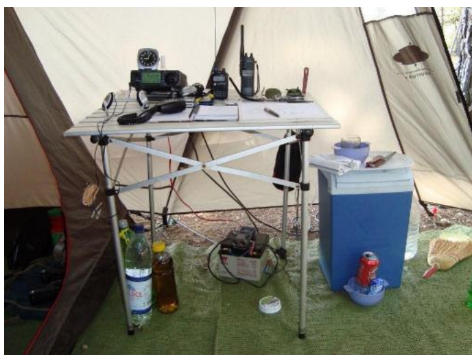
La station, IC-706 pour la HF, THF7 pour écholink et le GSM pour les SMS.
