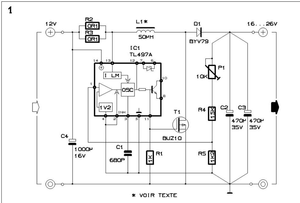
La valeur de la puissance de sortie maximale que peut fournir un convertisseur à accumulation ou en phase bloqué (fly-back) dépend de la valeur maximale du courant que peut supporter la bobine et de la fréquence de commutation. Au cours de chaque période un « paquet d'énergie » qui correspond à la quantité d'énergie maximale que peut fournir le système dans les conditions présentes, est transmis à la sortie.
