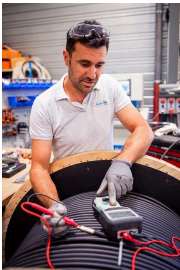
Un ingénieur ALSEAMAR effectue des tests sur une antenne filaire flottante
