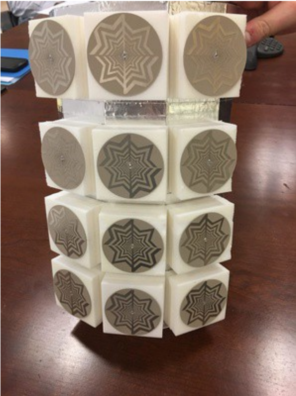
Éléments fractals à large bande pour un réseau MIMO multi-sectoriel.
