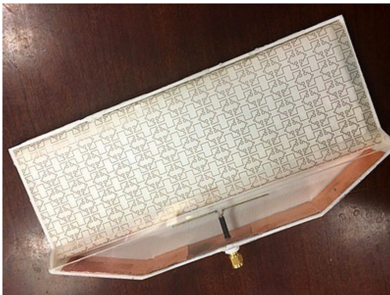
Exemple d'antenne fractale comme métamatériau pour un remplacement beaucoup plus petit de l'antenne Yagi.
