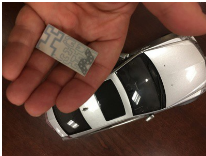
Exemple d'un réflecteur routier RCS amélioré pour voitures autonomes.
