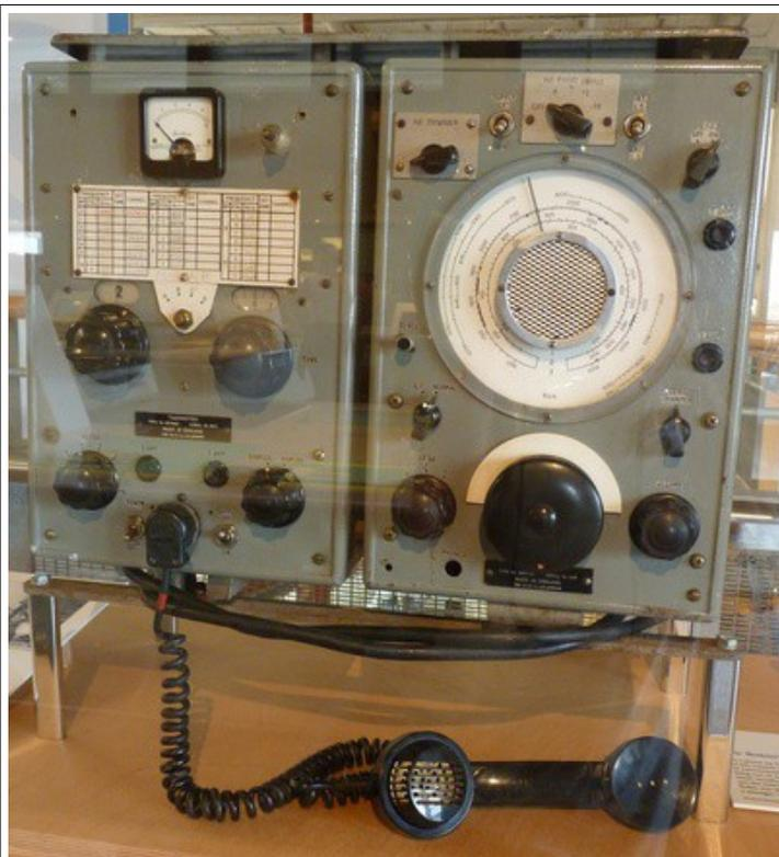
L'ensemble AM TX/RX Kestrel II fabriqué par Marconi Company. Le TX est équipé de 4 tubes HF TT22 avec un chauffage filament en 12 V.
