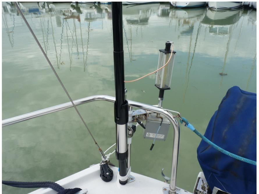
Le système de fixation. On notera aussi le choke balun à la base.
