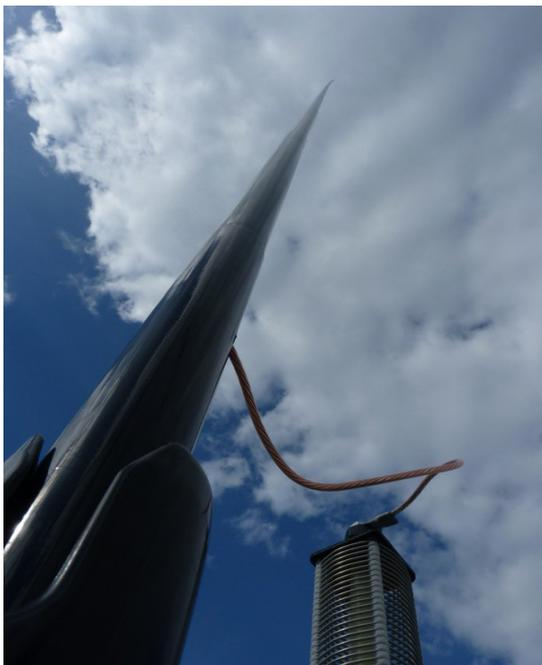
L'antenne fibre de verre, ici accordée sur 40 m.
