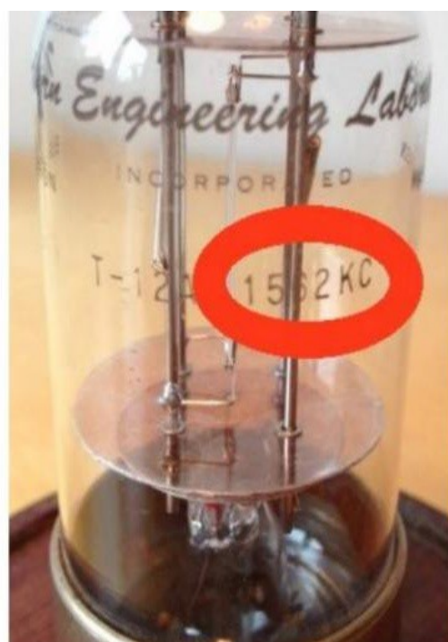
Modèles de cristal utilisés dans les émetteurs décrits dans ces trois épisodes Un blindage pouvait les recouvrir (DKARS Magazine, editie 32)
