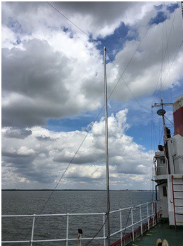
Milieu du dipôle 40 m sur le côté bâbord du Ross Revenge (2016)
