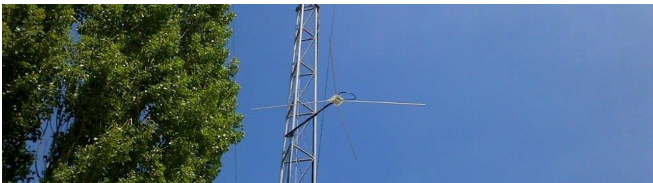
L'antenne de la balise ONØSIX : deux dipôles croisés à 8m de hauteur
