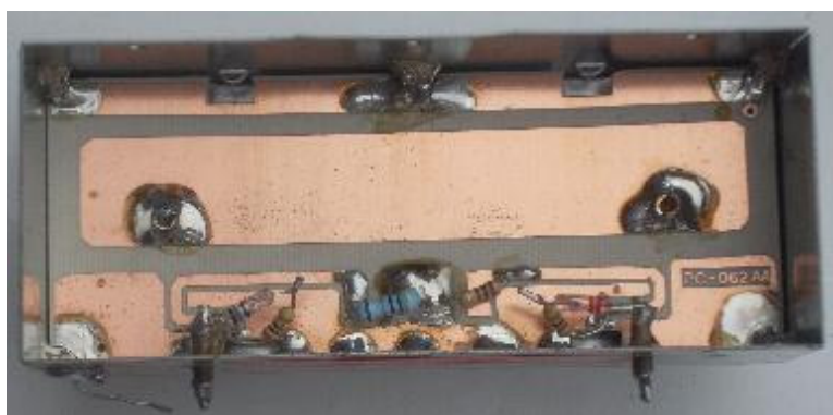
Vue interne du coupleur directionnel.
