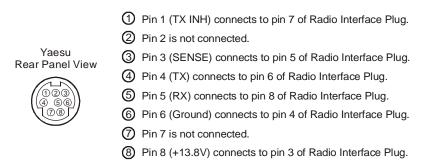
Figure 9. Yaesu Interface Cable (FT-100/-450/-857/-897/-950).
