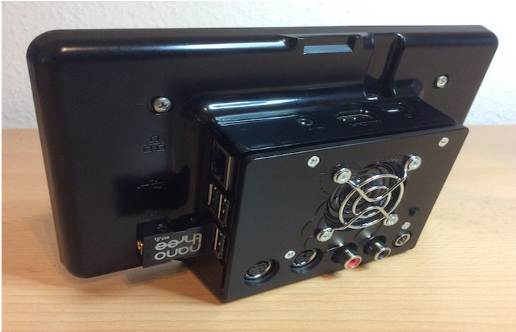
Arrière du Raspberry Pi 3+ 7" Touchdisplay, utilisé en contrôleur Sat SDR Nano à la station DL3DCW.
