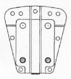
Gehäuse. 2 Halbschalen aus Polystyrol, verklebt, schlagfest, schwarz, uv-fest, Bruchlast 4.500 N Anschluß Koaxialleitung
